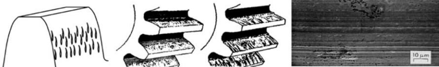
Oštećenje zuba u vidu otcepljenja
